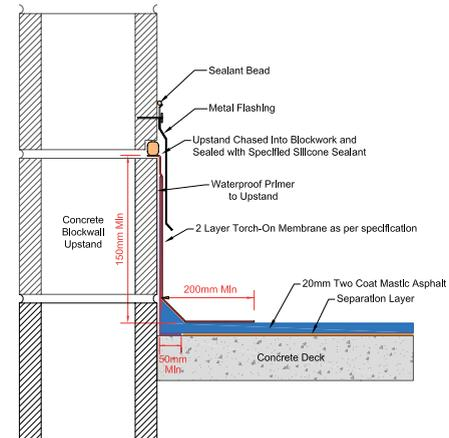
BLOCKWALL TORCH-ON UPSTAND DETAIL
