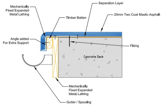
**GUTTER DRIP EDGE DETAIL**
